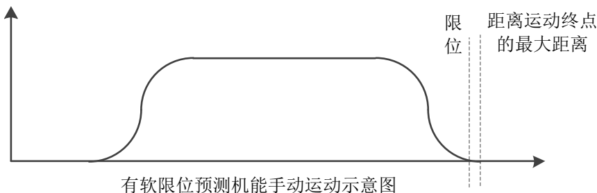
有软限位预测机能手动运动示意图
